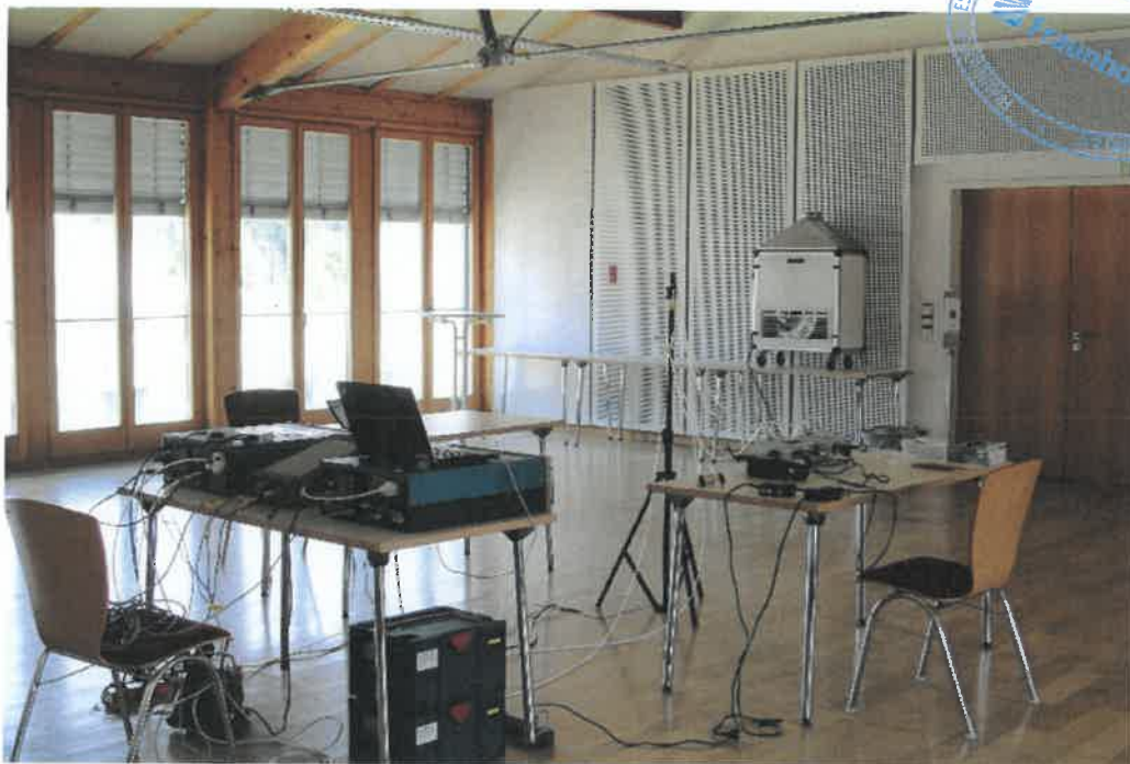
Bild 1: Konferenzraum am IBP mit dem zu prüfenden Raumluftreinigungsgerät.
